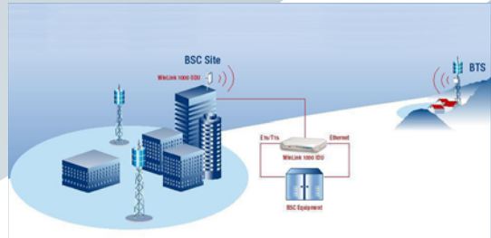
Подключение базовых станций сотовой сети
